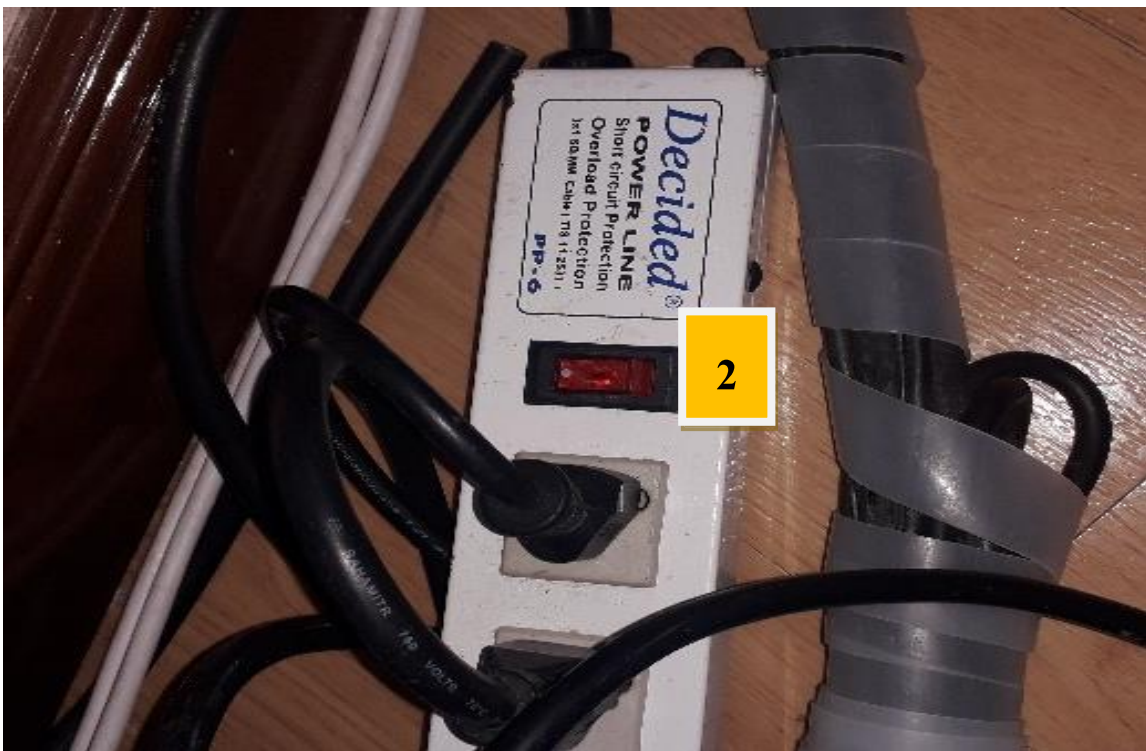
2. เปิดสวิตช์ที่ปลั๊กไฟ ให้มีไฟสีแดงปรากฏ
